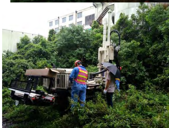
图 4-1 工作人员在钻井以采集土壤和地下水样品
